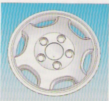
Bild 2: Mit Rev-Works eindigitalisierte Felge als Feature-Baum in Solid-Works.
