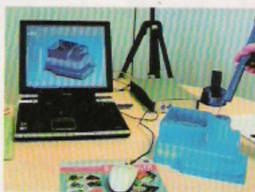
Bild 1: Erfassung von Gehäusemaßen mit dem 3D Creator direkt in Solid-Works.
